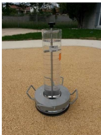
Figure 1 : Drainomètre de chantier utilisé in situ pour déterminer la drainabilité des revêtements réalisés
