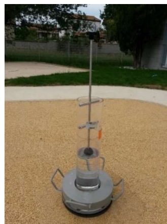
Figure 1 : Drainomètre de chantier utilisé in situ pour déterminer la drainabilité des revêtements réalisés
