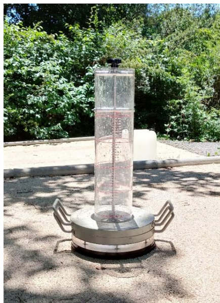
Fig 2. : Drainomètre utilisé pour réaliser les mesures in situ .
