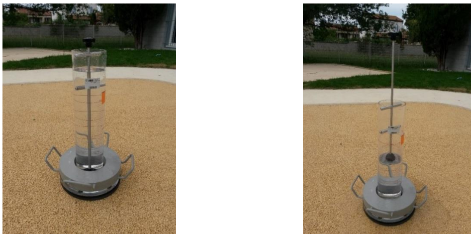
Figure 1 : Drainomètre de chantier utilisé in situ pour déterminer la drainabilité des revêtements réalisés
