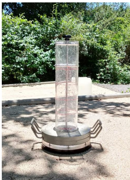
Fig. 1 : Drainomètre de chantier utilisé pour réaliser les mesures in situ .
